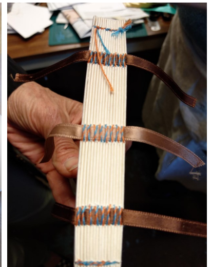
6 et 7 – Montage des cahiers sur tresse pour les assembler à l'aide d'une couture et résultat de l'opération.
