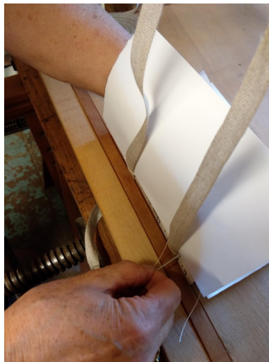
6 et 7 – Montage des cahiers sur tresse pour les assembler à l'aide d'une couture et résultat de l'opération.
